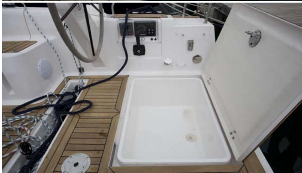
■ Zbog dva manja kormila, odnosno kola pomoću kojih se upravlja ovećim centralnim listom kormila, središnji dio kokpita i kormilarski dio palube uklopljeni su u jednu cjelinu što uvelike olakšava kretanje i ulaz na jedrilicu. Ispod krmenog palubnog prostora, namijenjenog kormilaru, nalaze se pak dva spremišta
