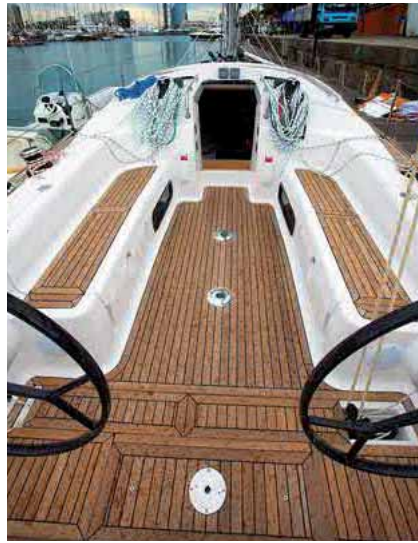
Barriere. Die Steuersäulen schränken die Bewegungsfreiheit ein. Der Traveller läuft versenkt, der Kanal wird im Hafen abgedeckt. Die beiden Räder lassen einen breiten Durchgang
